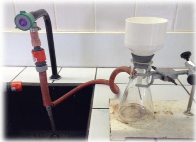
Sur le même principe, on réalise un pompage sous vide pour enlever le dichlorométhane du mélange et avoir ainsi seulement de la caféine. On place un bouchon en caoutchouc à la place du büchner. Le pompage sous vide dure environ 20minutes.
