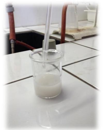
Filtrer la solution avec un système de filtration sous vide (voir schéma) pour avoir un mélange entièrement liquide. Pour ce faire, on utilise une fiole à vide avec un tuyau et sa trompe reliés à un robinet. On place un entonnoir (ou büchner) avec un joint en caoutchouc sur la fiole. Enfin, on place un filtre légèrement humidifié sur le büchner. La pression de l'eau issue du robinet va permettre la filtration de la solution.
