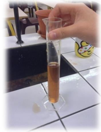
Prélever 10mL de dichlorométhane dans une poire à pipeter et les ajouter à la solution. Verser le mélange dans une ampoule à décanter à l'aide d'un entonnoir. Agiter et dégazer la solution, puis laisser décanter plusieurs jours.
